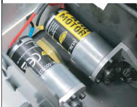
Die Anschlusskabel sind angelötet und die Getriebemotoren sind nun bereit für den Einbau in das Modell. Bitte beachten Sie hierzu die weiteren Einbauschnitte in der Aufbauanleitung des Modells.
